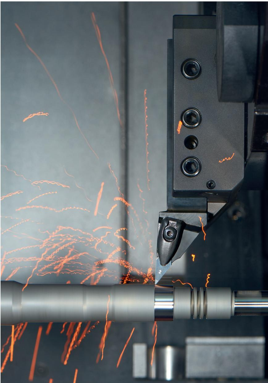
1 Das Drehen von Werkstoffen mit einer Härte um 60 HRC erfordert hochstabile, reaktionsträge Schneidstoffe wie CBN. Doch auch hier gibt es Leistungsunterschiede (© Walter AG)
